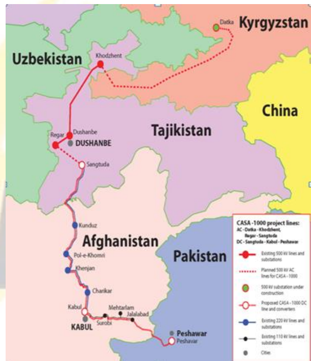
شکل ۲: مسیر لین انتقال پروژه کاسا ۱۰۰۰ [3]
